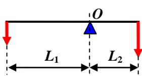
Рычаг должен иметь *точку опоры*  $O$ . Плечами рычага ( $L$ ) называют расстояния от точки опоры до линий действия сил, приложенных к рычагу. Условием равновесия рычага является соотношение  $F_1 \cdot L_1 = F_2 \cdot L_2$ . С помощью рычага можно получить выигрыш в силе, но, согласно «золотому правилу» механики, нельзя получить
