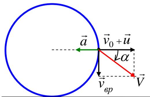
Сложение скоростей горизонтальных движений позволяет найти скорость центра колеса относительно неподвижного наблюдателя  $|\vec{v}_0 + \vec{u}| = 4 \text{ м/с}$ . Поскольку колесо катится без
