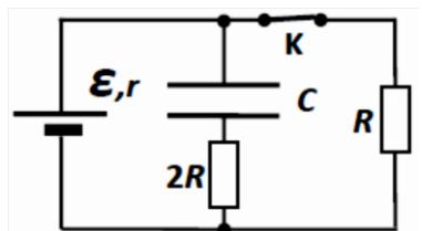
3.1. Определите увеличение заряда конденсатора после размыкания ключа. Ответ запишите в мКл с точностью до десятых.
