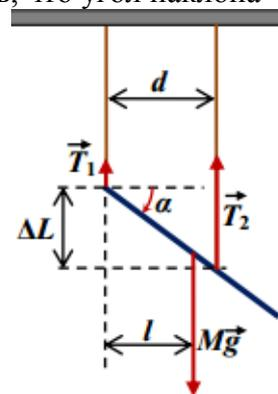
$T_1 = \frac{1}{5}Mg$ . Следовательно,  $\frac{T_2}{T_1} = 4$ . Каждая из сил натяжения пропорциональна удлинению нити, а коэффициент жесткости обратно пропорционален длине нити (см. вопрос). Значит,  $\frac{T_2}{T_1} = \frac{k_2 \Delta L_2}{k_1 \Delta L_1} = \frac{L_1 \Delta L_2}{L_2 \Delta L_1} \Rightarrow \frac{\Delta L_2}{\Delta L_1} = \frac{L_2}{L_1} \frac{T_2}{T_1} = 6$ .
