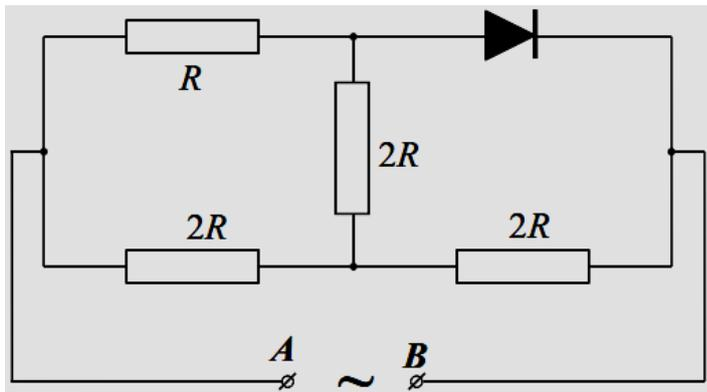
**Ответ:** В ту половину периода  $T$  синусоидального напряжения, когда потенциал  $A$  выше потенциала  $B$ , диода открыт, и в результате схема эквивалентна показанной на рисунке слева. В другую половину периода диод заперт, и схема эквивалентна показанной на рисунке
