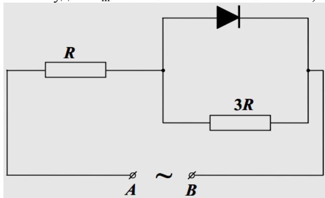
Подсказка 1: В ту половину периода  $T$  синусоидального напряжения, когда потенциал А выше потенциала В, диода открыт, и резистор с сопротивлением  $3R$  закорочен. Поэтому амплитуда синусоидального тока через резистор  $R$  равна  $\frac{U_m}{R}$ .
