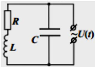
Подсказка 1: Ток через индуктивность и сопротивление  $I_{RL}$  – общий, причем напряжение на резисторе колеблется синфазно с током, а напряжение на индуктивности опережает ток по фазе на  $\frac{\pi}{2}$ . Поэтому на фазовой диаграмме вектора, отвечающие колебаниям этих напряжений, взаимно перпендикулярны.
