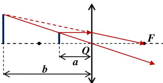
Как видно, линза формирует мнимое прямое увеличенное изображение, причем отношение размеров изображения к размеру объекта  $k = \frac{l'}{l} = \left| \frac{b}{a} \right|$  (напомним, что расстояние до мнимого изображения в теории тонких линз считается отрицательным). Согласно формуле линзы,  $\frac{1}{a} + \frac{1}{b} = \frac{1}{F} \Rightarrow b = \frac{aF}{a-F} \Rightarrow k = \frac{F}{F-a} = 2,5$ .
