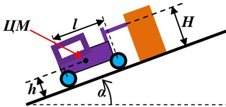
Подсказка 1: Используя условие равенства нулю проекции суммы сил, действующих на ящик, на направление вдоль наклонной плоскости, найдем, что сила, действующая на ящик со стороны электрокара  $F' = mg \sin(\alpha) + F'_{mp}$ . Так как ящик скользит, то  $F'_{mp} = \mu N = \mu mg \cos(\alpha)$ , и поэтому  $F' = mg[\sin(\alpha) + \mu \cos(\alpha)]$ .
