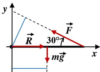
Плечо силы тяжести равно  $\frac{L}{2}$ , а плечо силы  $\vec{F}$  (расстояние от шарнира до линии действия этой силы) равно  $L \sin(30^\circ) = \frac{L}{2}$ , причем они вращают стержень вокруг шарнира в разных направлениях. Поэтому суммарный момент  $F \frac{L}{2} - mg \frac{L}{2} = \frac{1}{2} mgL = 5 \text{ Н}\cdot\text{м}$ .
