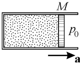
Подсказка 1: уравнение движения поршня с ускорением  $a$  имеет вид:  $Ma = pS - p_0S$ .
