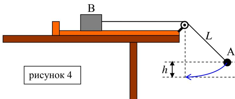
Подсказка 1: Скорость  $v$ , которую набирает груз, можно определить из закона сохранения энергии:  $mgh = \frac{mv^2}{2} \Rightarrow v^2 = 2gh$ .
