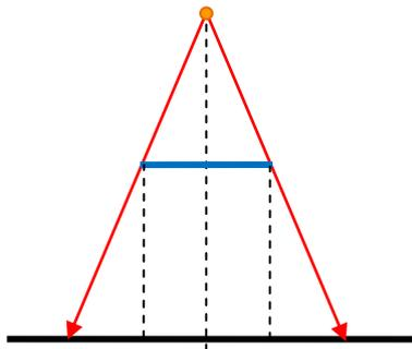
В направлении, параллельном лампе, возникает различие. Выполним построение в вертикальной плоскости, параллельной лампе, хода лучей от концов лампы, проходящих мимо краев экрана.
