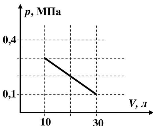
Подсказка 1: Уравнение этого процесса – линейная функция, которую можно записать следующим образом:  $p(V) = p_0\left(1 - \frac{V}{V_0}\right)$ , где, как видно из рисунка  $p_0 = 0,4$  МПа и  $V_0 = 40$  л.
