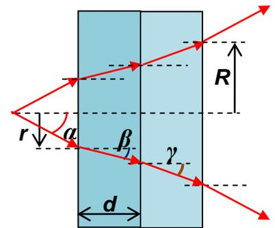
хода лучей (см. рисунок) видно, что  $R = r + d \cdot [\text{tg}(\beta) + \text{tg}(\gamma)]$ . Выражая тангенсы углов с помощью соотношения  $\text{tg}(\varphi) = \frac{\sin(\varphi)}{\cos(\varphi)} = \frac{\sin(\varphi)}{\sqrt{1 - \sin^2(\varphi)}}$ , найдем:  $\text{tg}(\beta) = \frac{1}{\sqrt{15}}$  и  $\text{tg}(\gamma) = \frac{1}{2\sqrt{2}}$ .
