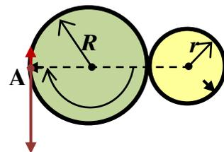
$V_{отн} = 5v \approx 1,26 \text{ м/с}$ . Отметим, что скорость точки вращающейся системы отсчета, совпадающей по положению в данный момент времени с изучаемой материальной точкой, часто называют *переносной скоростью* (в нашем случае это  $V_A$ ).
