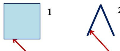
Найдите угол между падающим лучом и лучом, вышедшим из кубика. Также постройте ход луча, падающего на поверхность двугранного зеркала, плоскости которого образуют угол  $45^\circ$ , так, что происходит два отражения. Найдите угол между падающим лучом и лучом, отразившимся от обеих плоскостей зеркала.
