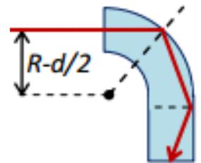
$\alpha_{ПВО} = \arcsin\left(\frac{5}{6}\right) \approx 56,4^\circ$ . При таком значении угла падения следующее
