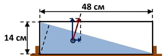
Архимеда) направлена вверх перпендикулярно поверхности жидкости. Поэтому ясно, что ускорение грузовика в процессе разгона направлено вправо по отношению к рисунку. Вертикальная составляющая силы Архимеда уравнивает вес жидкости в этом объеме, то есть  $F_{\text{зоп}} = \Delta m \cdot a$  и  $F_{\text{верт}} = \Delta m \cdot g$ . Поэтому, с учетом подобия треугольника, образованного силой Архимеда и ее проекциями и треугольника сечения жидкости, находим, что
