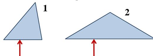
Сечением призмы 1 является равнобедренный треугольник с углом при основании  $50^\circ$ , причем луч падает на боковую грань этой призмы, сечение призмы 2 – равнобедренный треугольник с углом при основании  $30^\circ$ , и луч падает на ее основание.
