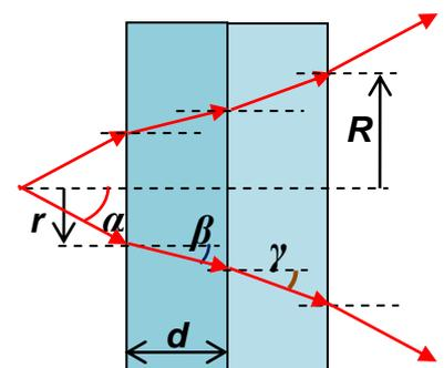
хода лучей (см. рисунок) видно, что  $R = r + d \cdot [\operatorname{tg}(\beta) + \operatorname{tg}(\gamma)]$ . Выражая тангенсы углов с помощью соотношения  $\operatorname{tg}(\varphi) = \frac{\sin(\varphi)}{\cos(\varphi)} = \frac{\sin(\varphi)}{\sqrt{1 - \sin^2(\varphi)}}$ , найдем:  $\operatorname{tg}(\beta) = \frac{3}{\sqrt{55}}$  и  $\operatorname{tg}(\gamma) = \frac{5}{\sqrt{119}}$ .
