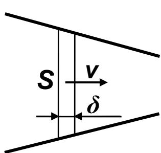
Рассмотрим движение «слоя» потока с очень малой толщиной  $\delta x$  и поперечным сечением  $S$  (ввиду малости толщины пренебрегаем его изменением). Масса этого слоя  $\delta m = \rho S \delta x$ , и увеличение его кинетической энергии при сдвиге в «соседнее» положение  $\Delta E_K = \Delta \left( \frac{\rho S \delta x v^2}{2} \right)$ . Сила, разгоняющая слой – это разность сил
