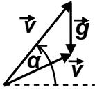
ускорением  $\vec{g}$  имеет вид  $\vec{v}(t) = \vec{v}_0 + \vec{g}t$ . Из полученного векторного треугольника (см. рисунок) находим, что  $v \cos(30^\circ) = v_0 \cos(60^\circ) \Rightarrow v = v_0 / \sqrt{3}$ . С другой стороны,  $gt = v_0 \sin(60^\circ) - v \sin(30^\circ)$ , откуда  $t = \frac{v_0}{g\sqrt{3}} \approx 0,23$  с.
