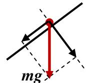
Составляющая силы тяжести вдоль поверхности равна  $\frac{3}{5}mg$ , и сила отталкивания колес
