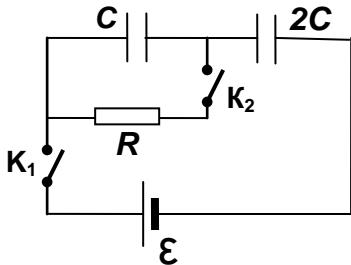
**Возможное решение:** После замыкания  $K_1$  батарея конденсаторов общей емкостью  $C_{общ} = \frac{2C \cdot C}{2C + C} = \frac{2}{3}C$  заряжается от источника до напряжения  $\mathcal{E}$ . Заряд каждого из конденсаторов  $q = \frac{2}{3}C\mathcal{E} = 1000 \text{ мКл}$ . На этой стадии ток через резистор не течет, и тепло в нем не выделяется.
