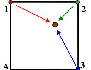
**Решение:** Квадрат расстояния от каждой из ламп до робота обратно пропорционален току соответствующего датчика, то есть  $r_1^2 = a^2 \frac{I_0}{I_1}$ ,  $r_2^2 = a^2 \frac{I_0}{I_2}$  и  $r_3^2 = a^2 \frac{I_0}{I_3}$ . С другой
